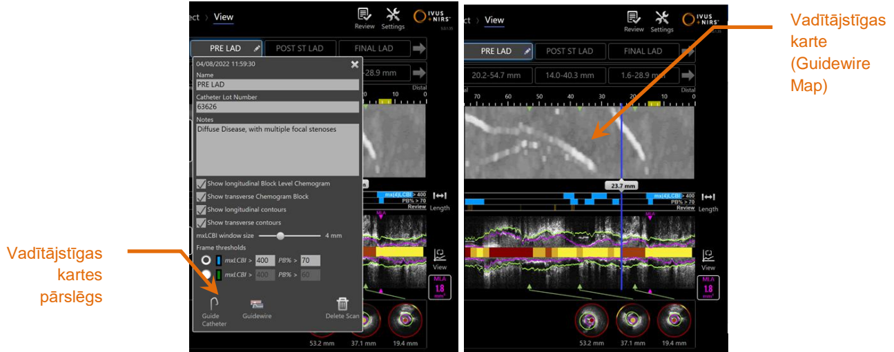
Attēls 10-4: Izmeklējumu labošanas logs ar iespēktu vadītājstīgas kartes pārslēgu (pa kreisi); Chemogram karte ir noslēpta un vadītājstīgas karte ir redzama (pa labi) (Viedā attēla izvēles iespējas iespējotas).
