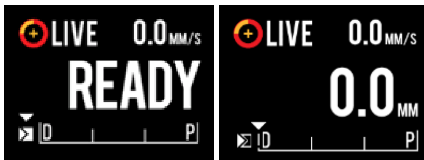
Attēls 9-2. Makoto® kontroles modulis, kurā redzama reāla laika IVUS datu apkopošana, kas netiek ierakstīta, READY pozīcijā (pa kreisi) un 0.0mm pozīcijā (pa labi).
